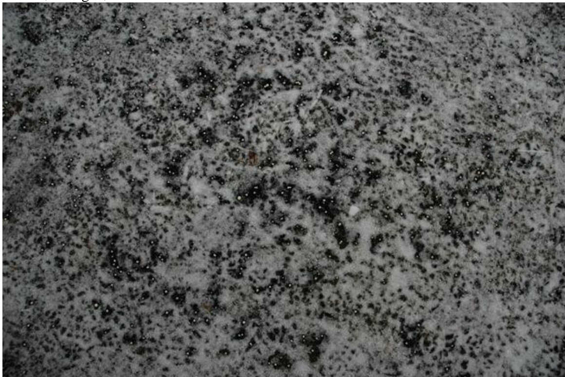
Bilde 2: Merk at man vanligvis ikke observerer effekten av CMA og NAAC direkte fordi de ikke smelter snøen, men effekten er forbløffende god ved at det ikke bygges opp is.
