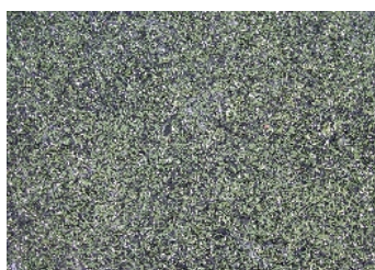
Figur 9 Forebyggende strøing med NAAC.
