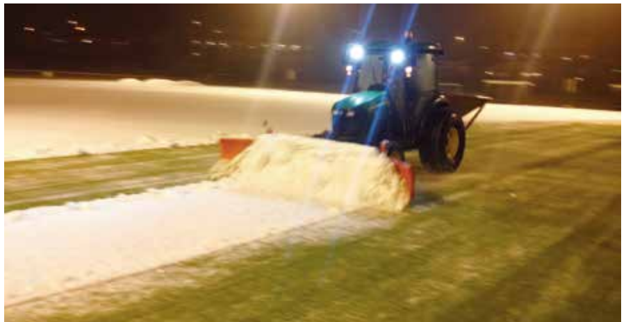
Godt utstyr er viktig ved vinterdrift av kunstgressbaner. Det er utviklet skjær som egner seg spesielt godt til fjerning av snø på slike baner, som denne utgaven utviklet av Parkmaskiner. Foto: Odd Einar Reseland
